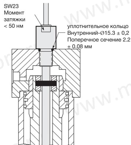
**Установка датчика с фланцем »С«**
