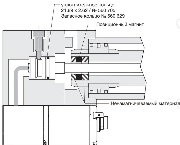
Отверстие в цилиндре  $\varnothing 13...17$  мм чтобы пропустить одиночные провода с плоским коннектором.
