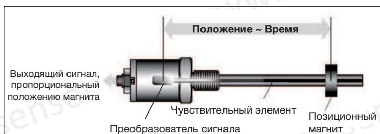
**Чрезвычайно прочный датчик Temposonics® RS** с превосходно экранированным корпусом гарантирует долгосрочное измерение линейного положения в самых суровых условиях. Герметично изолированный корпус сделан из нержавеющей стали, что полностью соответствует требованиям защиты IP68 и IP69K, и надежно экранирует против коррозии, проникновения грязи и воды.
