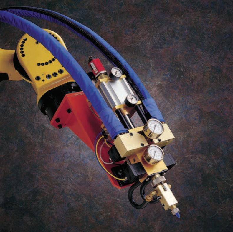
**Представьте...** минимальный размер точек склеивания, точное отношение при смешивании, филигранная отделка. Датчик гарантирует высокую точность дозировки из-за непрерывного измерения количества жидкости и скорости.
